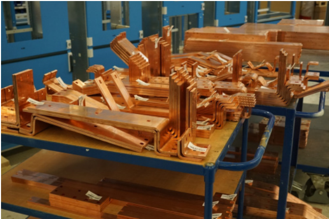
Bild 2 | Bereits vor dem Eintreffen der Schaltschrankgehäuse werden die Kupferschienen automatisiert gefertigt,...
